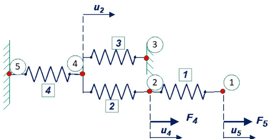
За відомими значеннями коефіцієнтів жорсткості елементів 1, 2, 3, 4 та сил  $F_4$  і  $F_5$  визначити переміщення точок 1, 2, 3, 4.
