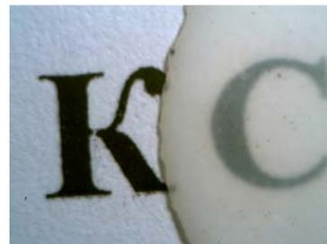
Рис.1 Оптическая нанокерамика состава YAG + 5%  $Nd_2O_3$  (до механической обработки)
